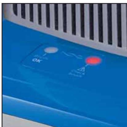
Bei Blockieren der Bürste schaltet der Sauger sofort ab
