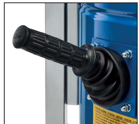
Manuelle Filterabrüttelung sorgt für permanent gute Saugleistung
