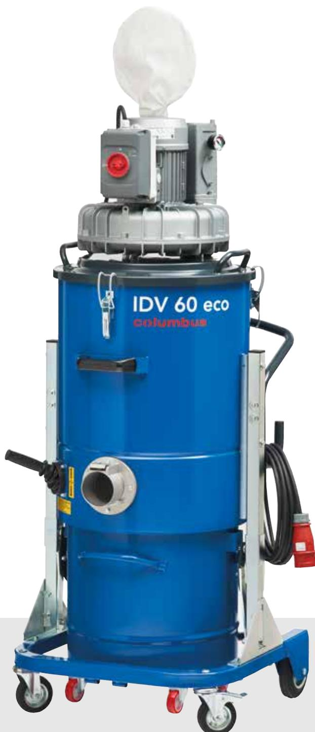
**Motor de turbinas de canal lateral:** En todas las aspiradoras industriales trifásicas, los motores trifásicos están equipados con turbinas de canal lateral. Son duraderas, sin necesidad de mantenimiento y diseñado para un funcionamiento continuo. La compresión doble del flujo de aire, en las turbinas de canal lateral, puede ser comparada con un motor de un enorme ventilador, produciendo una gran columna de aspiración.
