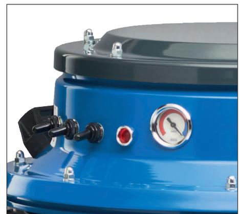
La visualización continua del indicador de vacío, permite saber la saturación del filtro en cada momento.
