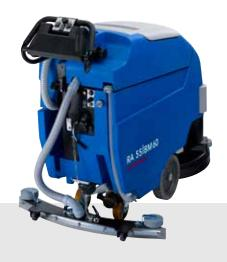
La construction à deux réservoirs garantit un nettoyage et une désinfection selon les normes d'hygiène HACCP.
