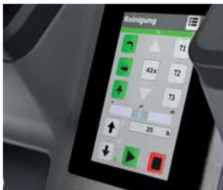
Le module d'affichage permet des cycles de nettoyage librement sélectionnables et une gestion simple des données numériques.
