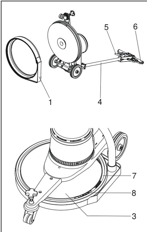
Fig. 8 : Montage de l'appareil d'aspiration
