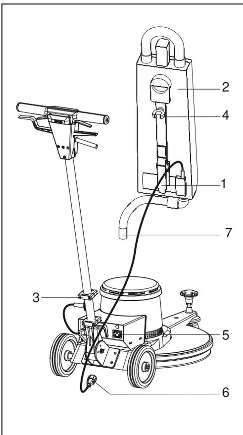
Abb. 9: Saugbehälter montieren
