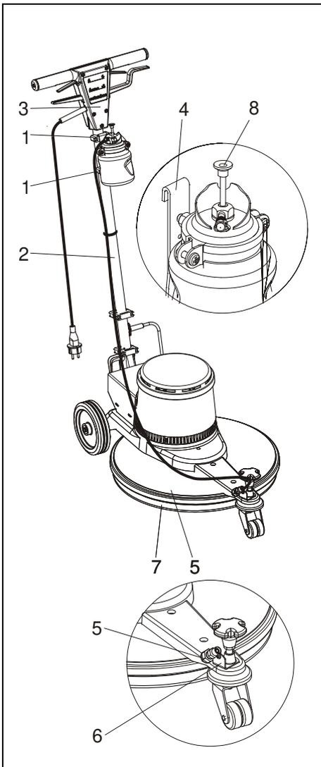
Abb. 7: Sprühgerät montieren
