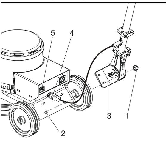
Abb. 5: Führungsstange montieren
