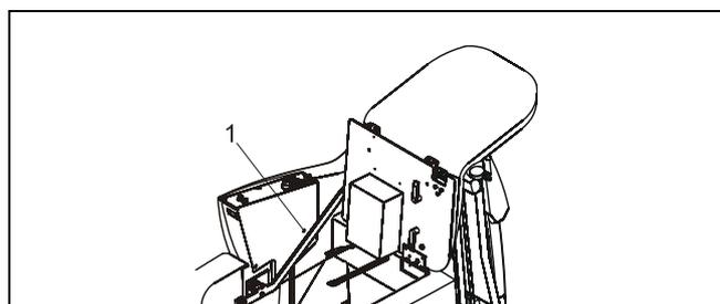
1. LED-Blinksignal von der Fahrsteuerung
