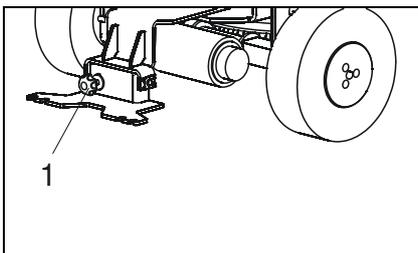
Mit der Sterngriffschraube (1) kann die Neigung der Gerätedüse eingestellt werden.
