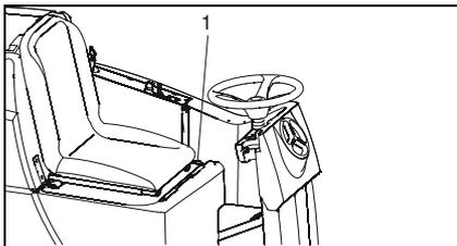
1. Hebel (1) zur Seite drücken und Fahrersitz nach vorne oder nach hinten schieben bis die geeignete Position erreicht ist und der Sitz hörbar einrastet.
