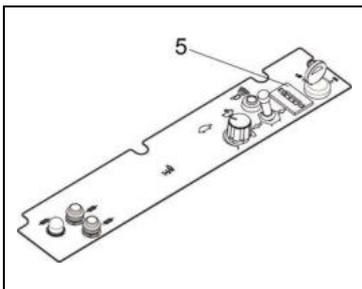
Beim Einschalten von Bürstaggregat oder Gerätedüse leuchten die Batterie-Überwachungsanzeige (5) zunächst in der Reihenfolge grün – gelb - rot. Danach wird der aktuelle Ladezustand der Batterien angezeigt:
