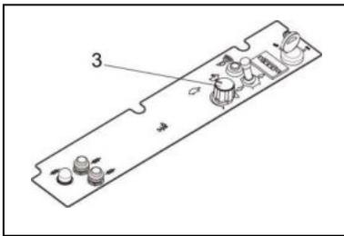
Mit dem Drehschalter (3) die maximale Fahrgeschwindigkeit einstellen.
