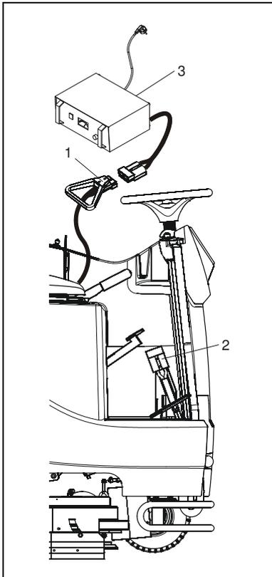
1. Reinigungsautomaten vollständig ausschalten, Batterieraum öffnen (siehe Kap. "Batterieraum öffnen").
