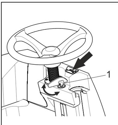
1. Bürstaggregat einschalten (siehe Kap. Bürstaggregat ein-/ausschalten).
