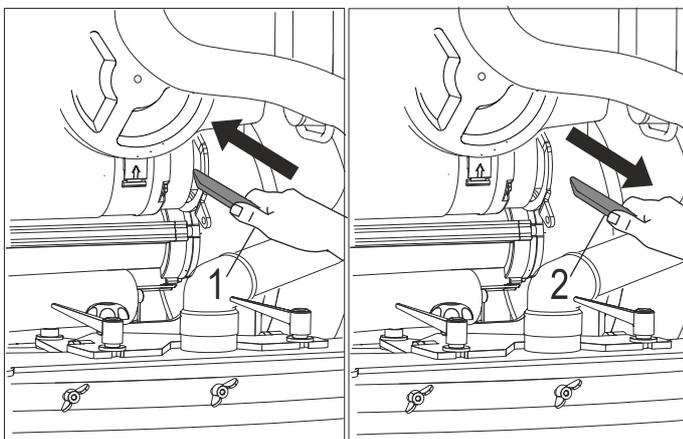
Soll der Reinigungsautomat ohne elektrische Versorgung fortbewegt werden, muss der Bremsenriegelungskeil (1) in die Fahrmotorbremse gesteckt werden. Die elektrische Fahrbremse ist ausgeschaltet und der Reinigungsautomat kann geschoben oder gezogen werden.
