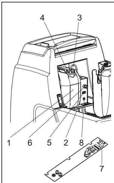
1. In die Einfüllöffnung des Frischwassertanks reines Wasser einfüllen (siehe 7.1.4 Reinigungsflüssigkeit einfüllen).
