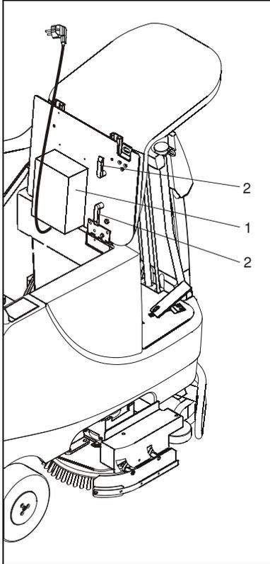
1. Reinigungsautomaten vollständig ausschalten, Batterieraum öffnen (siehe Kap. "Batterien einsetzen/entnehmen").
