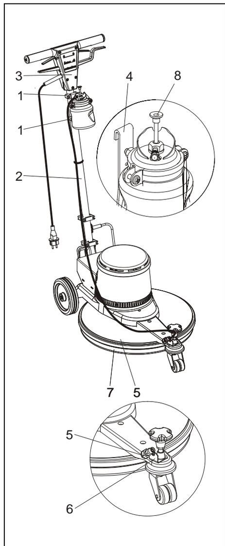
Figura 7: Montar atomizador
