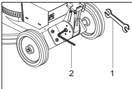
Fig. 11 : Ajustage de la charnière pivotante
