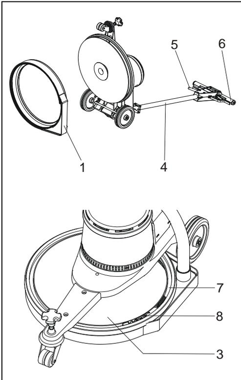
Fig. 8 : Montage de l'appareil d'aspiration
