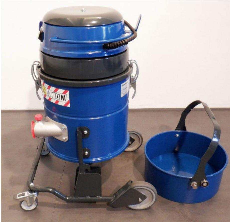
Leeren Sie die im Behälterinnern befindlichen Abfälle in einen geeigneten Behälter, der nach den im Betreiberland des Saugers geltenden Gesetzen der Entsorgung zuzuführen ist.
