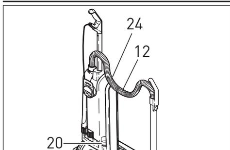
Zur Benutzung des Teleskopschlauchs (12) das Gerät immer in die aufrechte Position stellen. Dann das Saugrohr nach oben herausziehen und den Schlauch spannen, bis er einrastet. Zum Zurückstecken das Teleskoprohr erst in das Gelenk (20) einführen und es dann mit dem Griff auf den Nocken (24) am Filtergehäuse stecken. Der Schlauch gleitet dann zurück und kann auch ohne das Saugrohr benutzt werden. Die Saugdüsen (16,17) passen auf das Saugrohr und den Schlauch.
