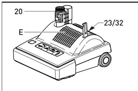
Wir empfehlen, den Abluftfilter (32) zusammen mit dem Micro-Hygienefilter (30) auszutauschen. Der Abluftfilter (32) befindet sich unter dem Deckel (23) auf der Rückseite des Kehrsaugkopfes.
