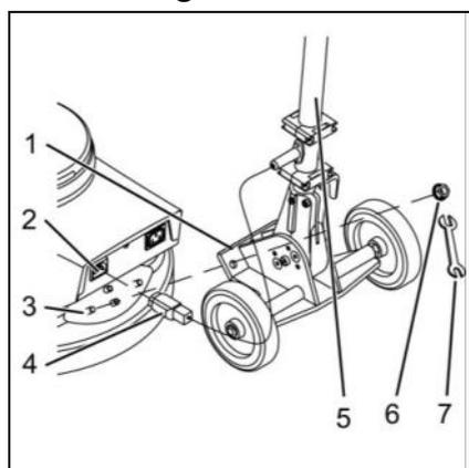
Fig. 5 : Montage du manche de guidage
