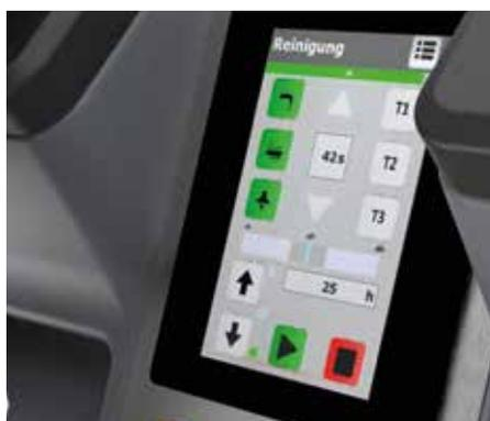
Das Display-Modul ermöglicht frei wählbare Reinigungszyklen sowie einfache digitale Datenverwaltung.
